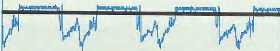
Fig.23 Quando il Meteosat trasmette immagini molto BIANCHE, il segnale rimane prevalentemente in alto verso la linea del livello Bianco, per scendere verso la linea inferiore del livello Nero solo quando nell'immagine vi sarà una zona nera.
